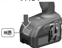
<그림 13> <배터리 분리>
